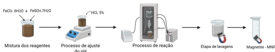
Figura 1 – Subsequência da formação das nanopartículas magnéticas.
